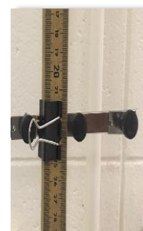
Clip de presión para fijar la regla al sostén S
